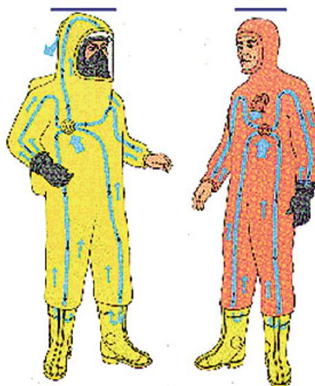
Ventilación y presión positiva.
