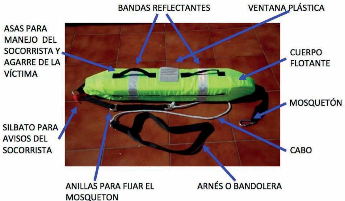
Se trata de un cartucho de espuma compacta forrado de material plástico o lona que le confiere una gran flotabilidad. Dispone en un extremo de una cinta de pequeñas dimensiones con un mosquetón. En el otro extremo cuenta con una cinta, de unos 3 metros con varios puntos para unir el mosquetón, termina en una cinta gruesa para que se la coloque el rescatador a modo de bandolera.
