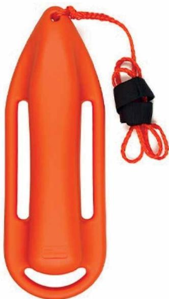
Es un DFR, dispositivo flotante de rescate de la familia de materiales de contacto, construido en polietileno moldeado con tres huecos en forma de asidera para que se puedan agarrar las víctimas en uno de sus extremos incorpora un cabo o cinta de nylon de dos metros, el rescatador se la pondrá en forma de bandolera para liberar sus mano y poder nadar.
