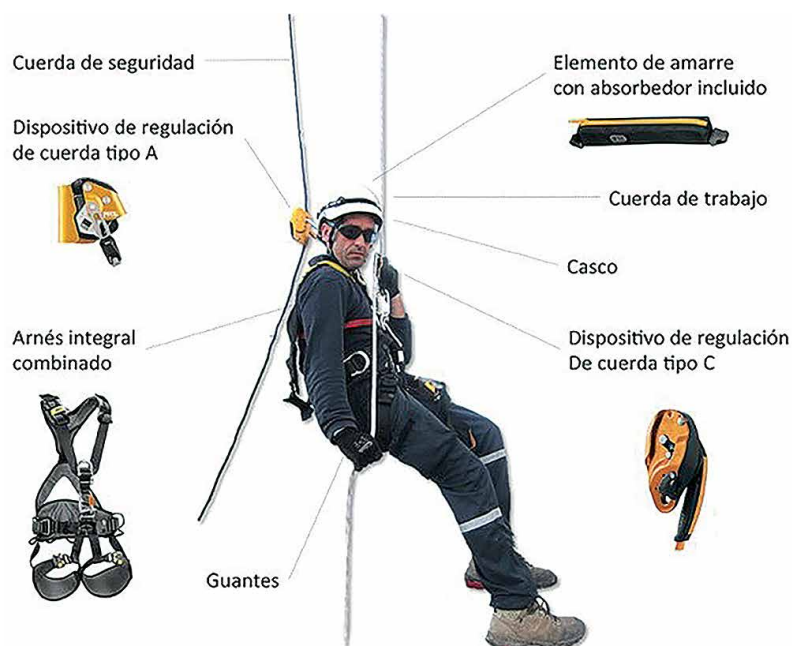
Elementos del sistema de acceso mediante cuerda.
