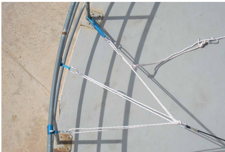
Repartidores de carga con lazo de cuerda (A) y con cintas EN 795 B (B).
