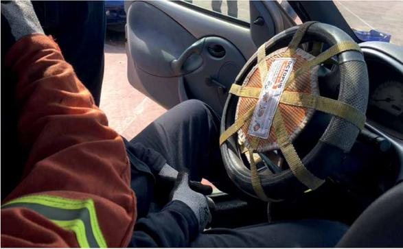
“El protector de airbag de conductor da una falsa seguridad, este no impide su activación, solo disminuye la distancia de expansión de la bolsa del propio airbag, mantener, aunque menor, la distancia de seguridad”.
