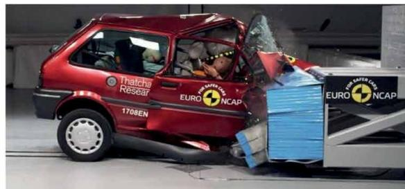
¿Qué son los sistemas de seguridad estáticos? Son todos los sistemas cuya finalidad es la de absorber la mayor parte de energía en un impacto, con el objetivo de mantener la célula de habitabilidad intacta y evitar que esa energía sea transferida a los ocupantes.
