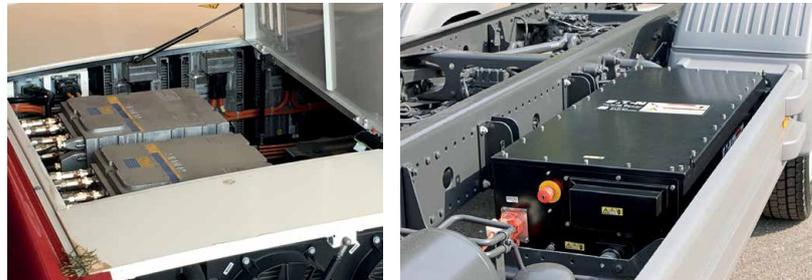
Las baterías AT suelen disponer de interruptor manual de servicio o "Plug Service", que anula el intercambio de energía de la batería de alta tensión hacia el resto del vehículo. Su colocación y tipo de mecanismo es también muy variable. Ejemplos:
