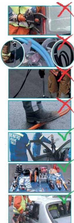
1. Cuando maneje una herramienta nunca se coloque entre la herramienta y el vehículo.
