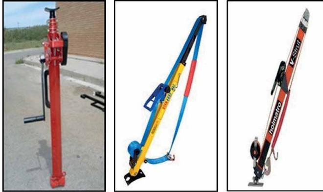
Weber. Diferentes modelos y tamaños, indicado para vehículos ligeros, cabinas de camión (según modelo), extensión manual, tensado por carraca, extensión máxima según modelos 1720 mm – 2500 mm, máxima carga en dirección longitudinal del puntal según los diferentes modelos 1500 kg – 2500 kg, longitud de la cinta según modelos 5000 mm - 10000 mm.
