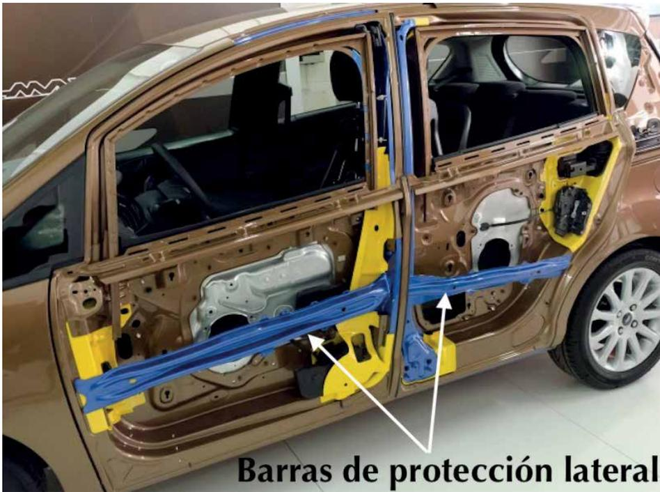
2. **Zonas fusibles o programadas:** cuando se produce un accidente la estructura del vehículo se somete a una violenta desaceleración, la cual es transmitida a sus ocupantes. Para proteger a los ocupantes, la estrategia adoptada será dotar de zonas de deformación programada en sus extremos y un habitáculo rígido que asegure la integridad de la cabina y de sus ocupantes.
