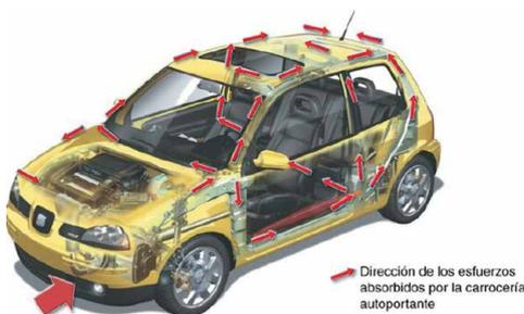
En estas zonas, la absorción de la energía se produce por medio de deformaciones de piezas programadas para ello, además de la dispersión de la energía hacia otros sectores del vehículo como se muestra en la imagen.
