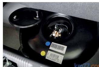
En caso de liberación de la válvula de seguridad o fuga de gas, se dirigirá a través del tubo de escape al exterior, normalmente hacia el suelo
