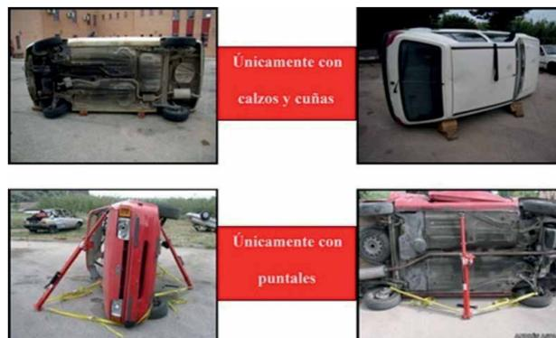
*Recordar: realizar el tensado del puntal o puntales de la parte trasera únicamente cuando se haya asegurado la parte delantera, ya que existe el riesgo, de no hacerlo así, de volcar el vehículo en posición sobre su techo.*
