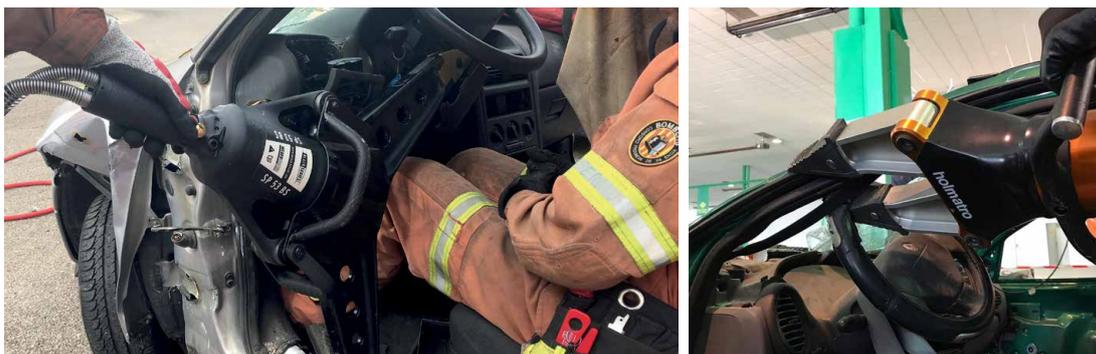
Hay diferentes técnicas para desatrapar al conductor o acompañante del tablero o salpicadero. Según la deformación que presente, del tipo de accidente, del modelo de vehículo accidentado, de las herramientas que dispongamos, etc., podemos realizar un desplazamiento, un levantamiento o utilizar otras técnicas. En este manual veremos el procedimiento para desplazar y levantar un tablero.
