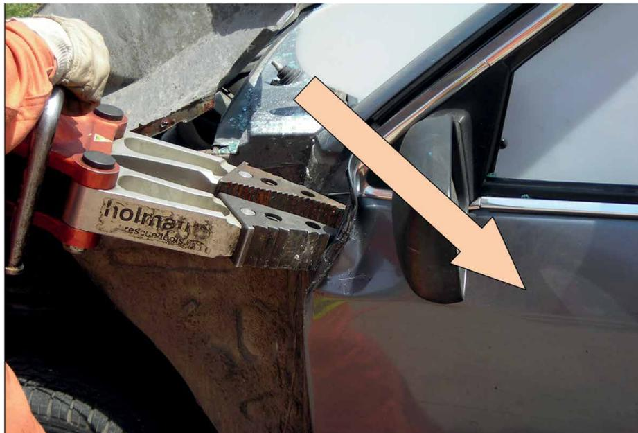
a. Vehículo sobre sus ruedas: Técnica de apertura y retirada.
