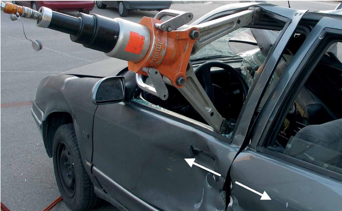
3. Introducir el separador y comprimir la aleta hasta generar el espacio necesario. (En ocasiones, si no se coloca bien el separador sobre la aleta, tiende a resbalar, por tanto, prestar atención en la colocación del separador).
