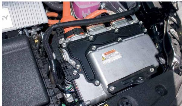
*Cableado naranja conectado al inversor/convertidor.*
