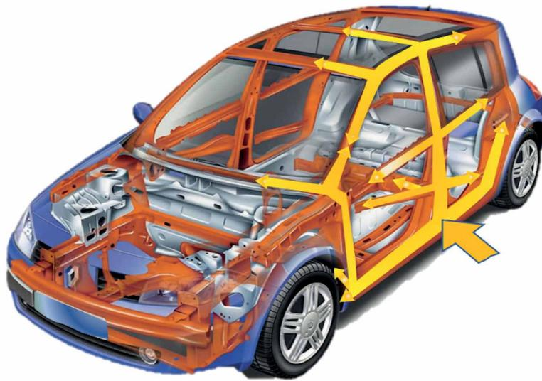
**¿Cómo nos afecta a los bomberos, estos nuevos materiales en las estructuras?** En general, nos puede afectar a la hora de realizar cualquier corte o separación en una de estas zonas. Para poder realizar los cortes, utilizaremos las zonas más idóneas y herramientas con gran capacidad de corte. **Hoy en día la herramienta hidráulica que más ha evolucionado es la cizalla.**
