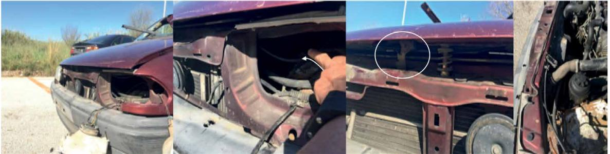
2. **Técnica de apertura del capó.** Colocando las puntas del separador entre el hueco que hay entre el parabrisas y el capó, abrir el separador hasta crear el suficiente hueco para poder desconectar la batería.
