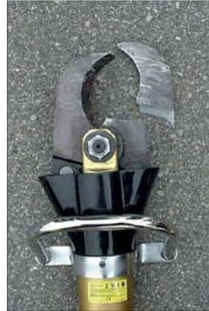
**Recordar: las bisagras están fabricadas con aceros de alta dureza. En general no intentes cortar una bisagra. Utiliza otros sistemas alternativos para retirar las puertas y lograr acceso.**
