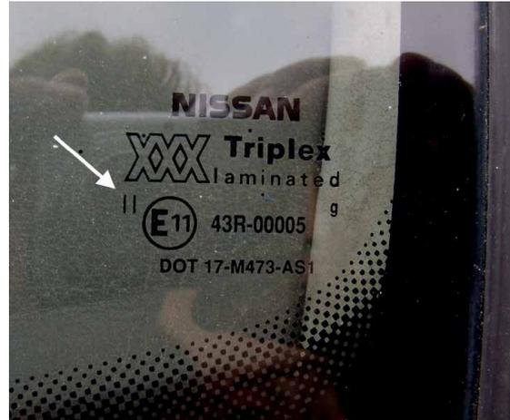
**Recordar: el cristal laminado para retirarlos se tiene que cortar (sierra manual, sierra de sable, etc.) y los cristales templados se rompen (cerámica de una bujía, rompe cristales, etc.), salvo que estos dos tipos de cristales esten calzados, en este caso tambien los podremos retirar cortando y retirando la goma que sujeta el cristal y asi evitaremos mayores riesgos, como los trozos de cristal, el polvo que desprenden a cortarlos, etc.**
