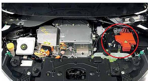
*Batería auxiliar Renault ZOE eléctrico*
