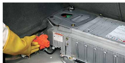
**¡OJO!** La AT se mantiene en el interior de la batería y los condensadores mantienen unos minutos su tensión. Ejemplo: Toyota Prius III Híbrido 2010 = **10 minutos**.
