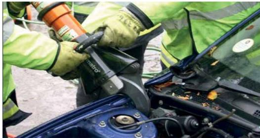
4. Ahora podemos empezar a extender el ram. Siempre tendremos que vigilar los puntos de apoyo durante toda la operación y comprobar que los pies estén por debajo de los pedales antes de desplazar o levantar el tablero. Si por alguna razón la operación se suspende, cuando empecemos de nuevo poner atención en el accionador manual de control y evitar que comience a descender el ram accidentalmente.
