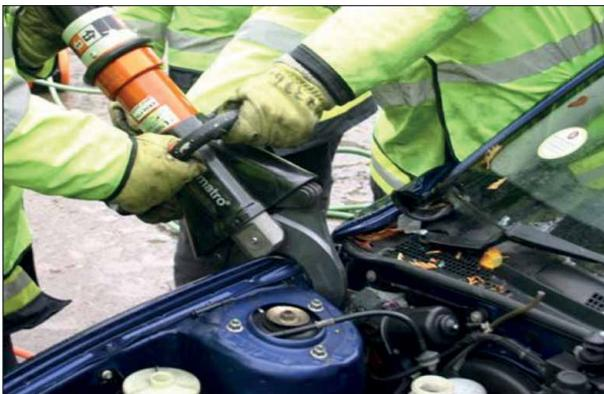
5. Colocar las puntas del separador en el hueco creado e iniciar el levantamiento hasta liberar a la víctima. Recordar vigilar constantemente las puntas del separador, recolocar si fuese necesario. Prestar atención en el accionador manual de control para evitar cualquier movimiento indeseado.
