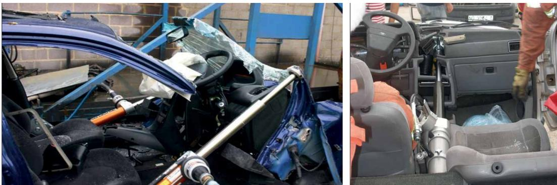
Esta maniobra será la última a realizar, **primero crear hueco para la extracción plan B** (retirada de una puerta, medio techo hacia delante, un lateral, etc.) **y después quitar el atrapamiento**. Se puede hacer simultáneamente, mientras unos preparan la salida otros preparan el desatrapamiento.
