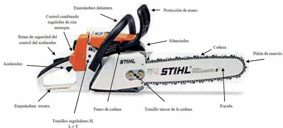
Elementos de la motosierra. (Fuente. J. Mozos).
