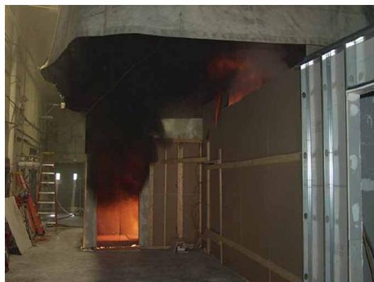
*Efecto del VPP sobre los gases de la puerta de acceso.*
