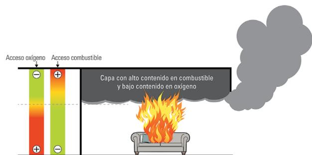
Una alta concentración de combustible que asciende gradualmente, hará que las llamas alcancen la parte inferior de la capa de gases del incendio.
