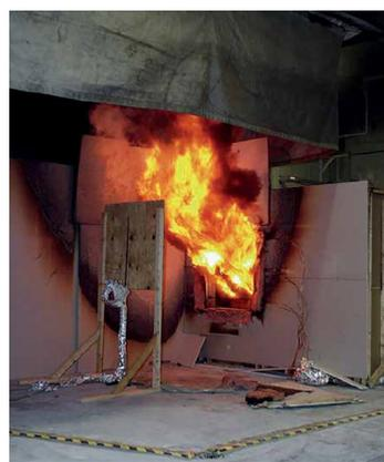
*Longitud de las llamas en ventana de salida. Ensayo VPP*
