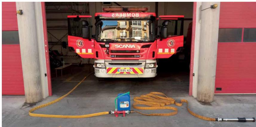
*Instalación espuma baja expansión, con premezclador y garrafa.*
