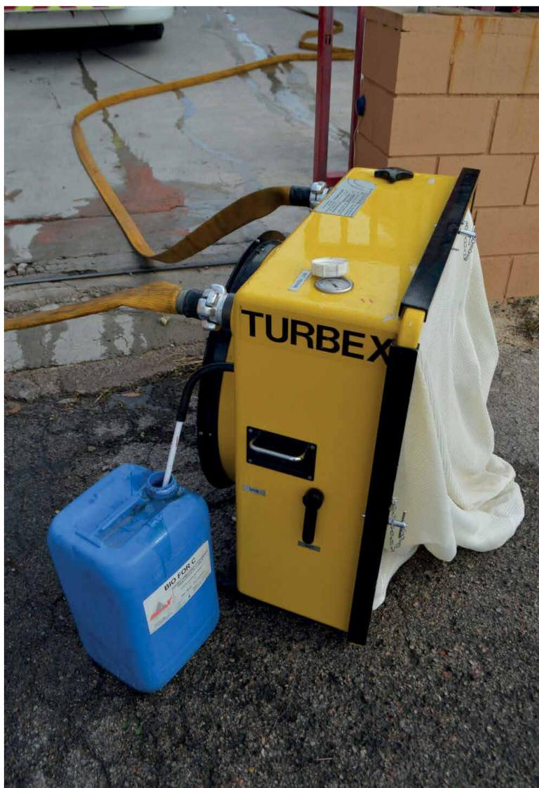
*Generador espuma alta expansión Turbex.*
