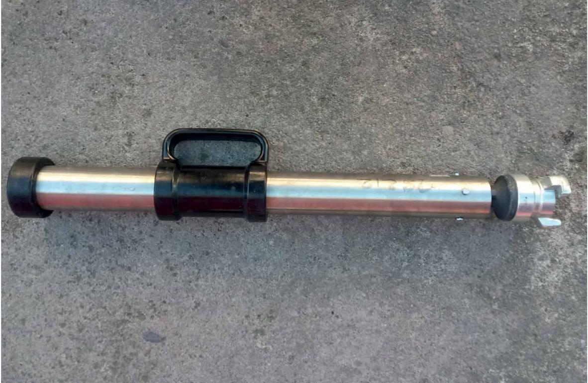
*Lanza formadora de espuma de baja expansión.*
