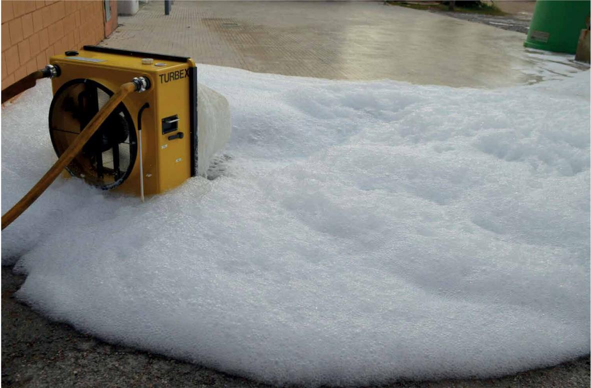
*Inundación mediante espuma de alta expansión.*
