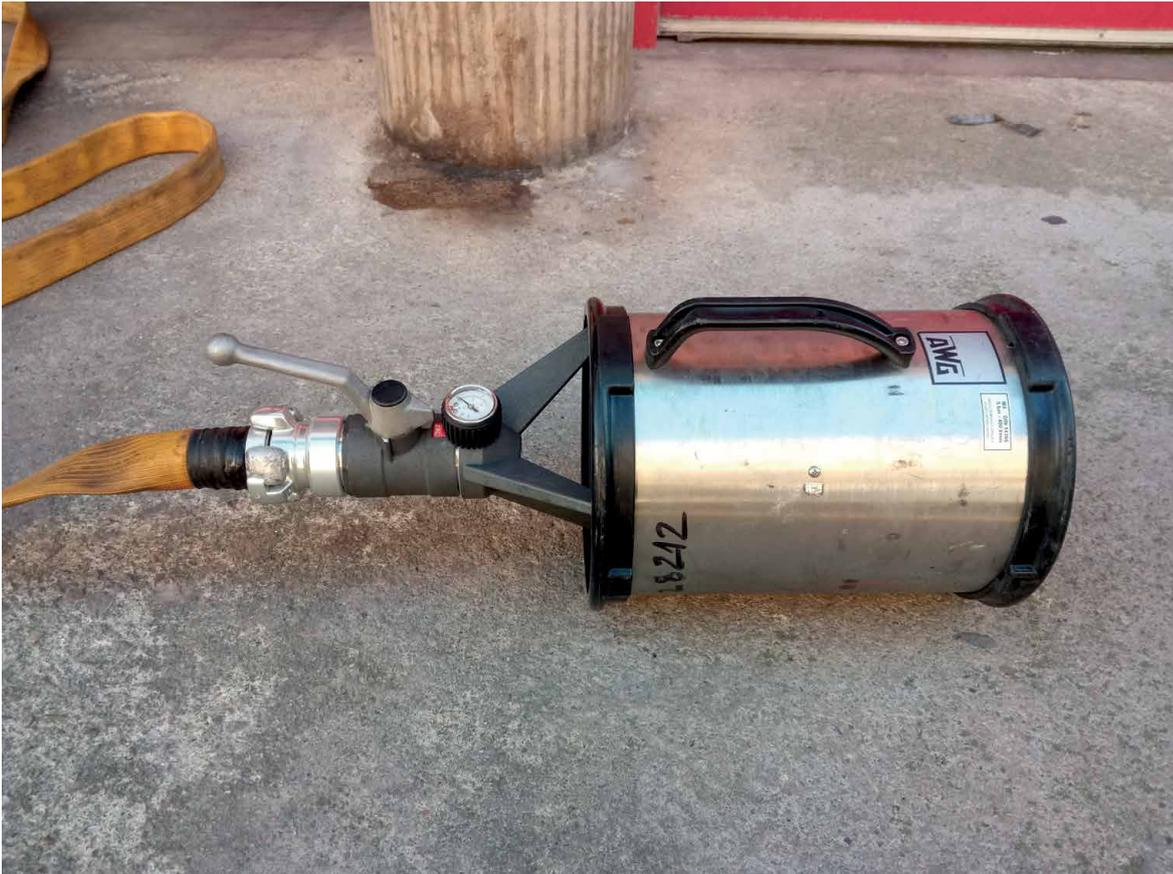
*Lanza formadora de espuma de media expansión.*
