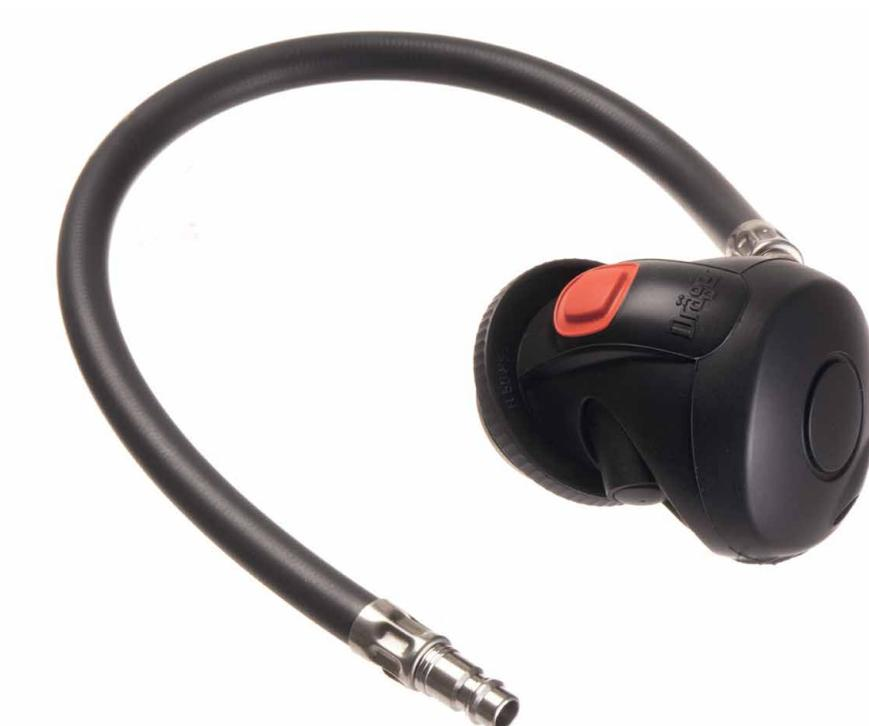
En su interior existe una válvula a demanda, que se abre por la acción de la primera inspiración de los pulmones, dando paso al flujo de aire hacia la máscara y permitiendo, a partir de ahí, una presión positiva en el interior de la máscara, lo que evitará la entrada de cualquier contaminante.
