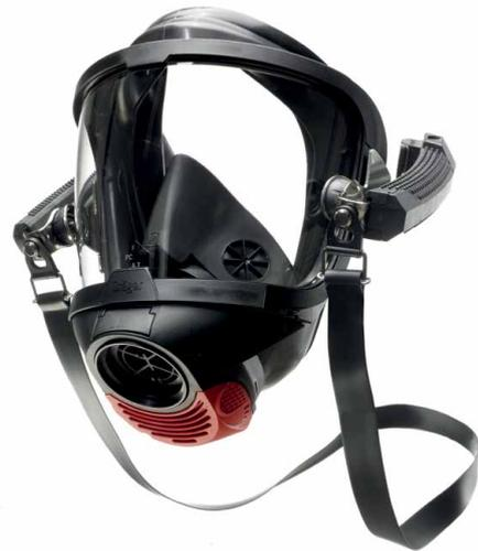
La pieza interior, denominada semi-máscara, ayuda a la conducción del aire, evitando la mezcla del aire limpio que entra en la máscara, con el aire ya exhalado. El aire que pasa por la válvula de inhalación entra barriando el visor por dentro, penetra en la semi-máscara a través de las dos válvulas unidireccionales situadas a ambos lados de la nariz y es inhalado entonces por el usuario. El aire que
