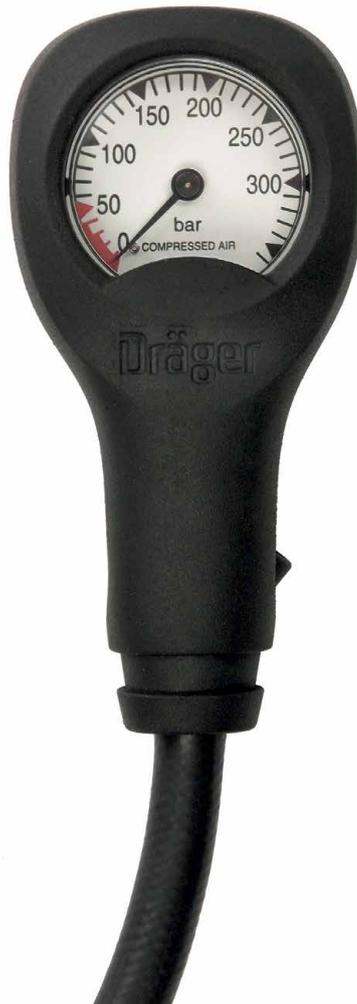
Es el indicador convencional de presión. A través de un latiguillo conectado a la entrada de alta presión del manorreductor, está recogiendo permanentemente la presión de la botella de aire. La banda de presiones entre 50 y 0 bares va marcada con color, que puede ser en algún caso amarillo fluorescente, para que resalte en la oscuridad.
