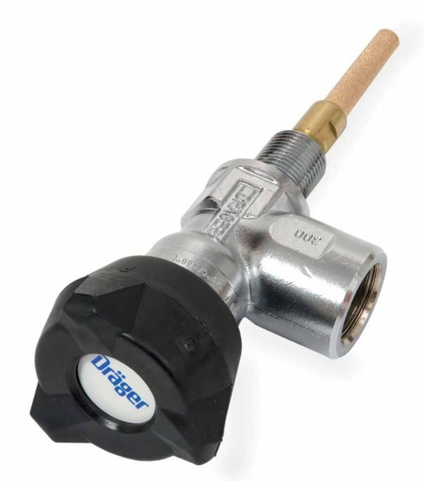
En su otro extremo, el grifo debe roscar con el manorreductor, cuando la botella de aire se monta en la espaldera del ERA. Esta conexión roscada está normalizada por UNE EN 144-2:1999.
