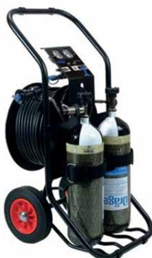
Constan de un suministro de aire en uno o dos botellones transportables sobre un carro o incluso en un compresor portátil, y un carrete con 20 o 30 metros de latiguillo que lleva el aire hasta el usuario, que puede estar trabajando a distancia.
